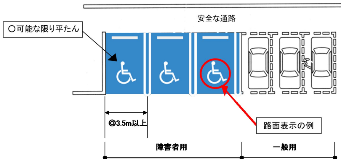
図 3-8 障がい者用駐車マスの構造の例
